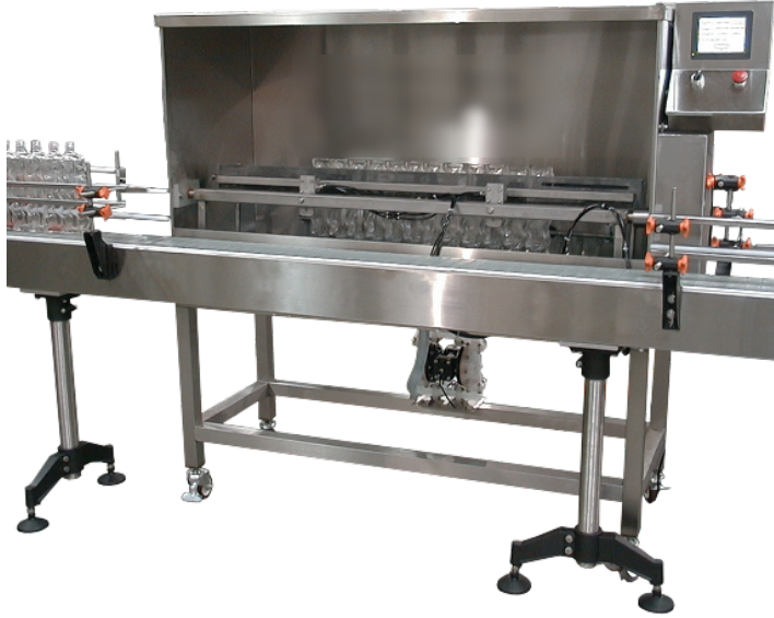
Şekil 6.16.90. Şişe devirmeli, kuru hava şişe temizleme makinesi
